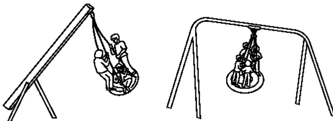
Фиг.2. Люлки с една точка на окачване
